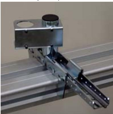
7. Atornille 4 tornillos de presión en los agujeros en uno yugo de tubos. Deslícelo en el tubo de la apoya. Gire el yugo a la posición aproximada, y apriete los tornillos contra el tubo.
